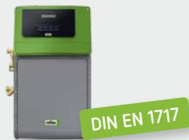
Die Fillcontrol Auto Compact arbeitet vollkommen unabhängig vom Druck des Frischwassernetzes. Sie kann sowohl druck- als auch niveaubhängig betrieben werden, die Einstellung erfolgt einfach über die Control Steuerung. Beim niveaubhängigen Betrieb werden Druckhaltestation und Nachspeisung direkt per Steuerung miteinander vernetzt. Die Fillcontrol Auto kann dank integriertem Netztrennbehälter direkt an das Trinkwassernetz nach DIN 1988 angeschlossen werden.
