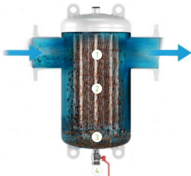
1. Die Strömung wird durch einen Bereich mit größerem Querschnitt als die Anschlussdimensionen geführt, um die Fließgeschwindigkeit zu reduzieren. Durch die längere Verweilzeit in dem Abscheider und die Schwerkraft sinken Schmutzpartikel ab.
