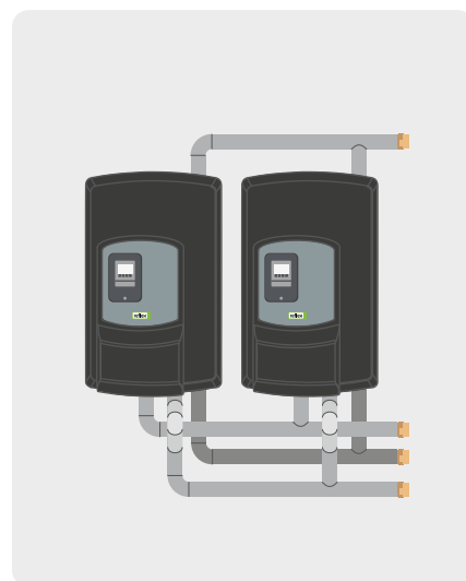
Tubazioni di cascata orizzontali verso destra di due Reflex Hydroflow L
