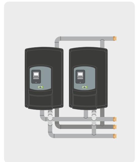
Kaskadenverrohrung horizontal nach rechts von zwei Reflex Hydroflow L
