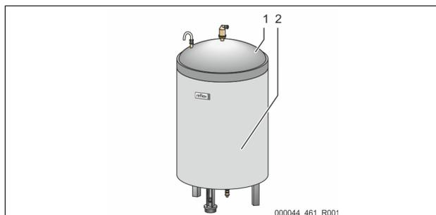
Уложите опциональную теплоизоляцию (2) на основном резервуаре (1) и закройте изоляцию застежкой.
