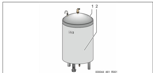
Verlegen Sie die optionale Wärmedämmung (2) um das Grundgefäß (1) und verschließen Sie die Wärmedämmung mit dem Reißverschluss.
