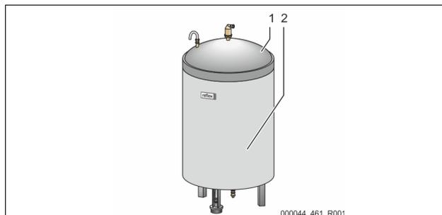
Tegyük le az opcionális hőszigetelést (2) az alaptartály (1) köré, és a hőszigetelést a cipzárral zárjuk le.
