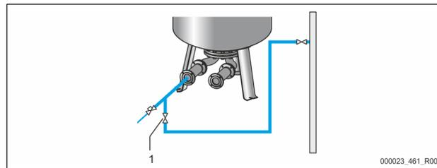
For å fylle grunnbeholderen med vann, bruker du helst en vannslange hvis den automatiske ettermatingen ikke er tilkoblet ennå.
