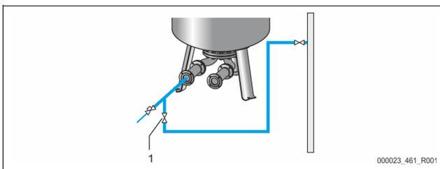
Para o enchimento do vaso básico com água deve ser utilizada preferencialmente uma mangueira de água, se a realimentação automática ainda não estiver ligada.
