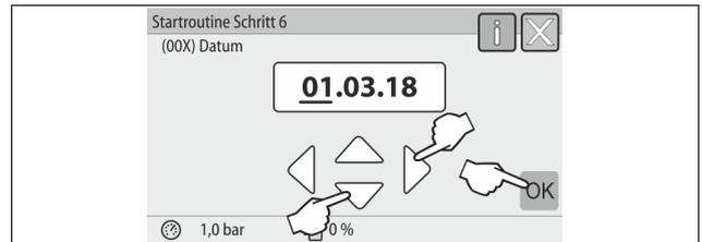
6. Stellen Sie das Datum ein. Das Datum wird beim Auftreten eines Fehlers im Fehlerspeicher der Steuerung abgelegt.
