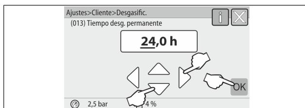
7. Ajuste el periodo de la desgasificación permanente.
