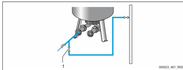
Välj en vattenslang för påfyllning av baskärl med vatten om den automatiska eftermatningen ännu inte är ansluten.
