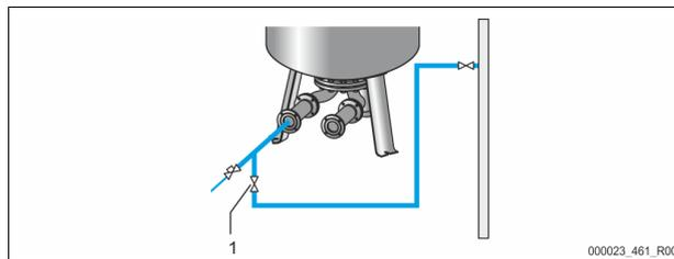
Jeżeli automatyczne uzupełnianie wody nie jest jeszcze podłączone, do napełnienia zbiornika podstawowego wodą zaleca się użyć węża.
