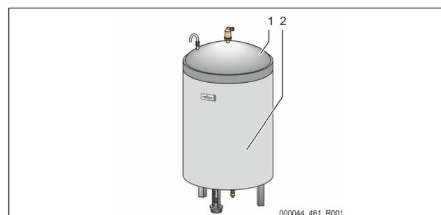
Posare l'isolamento termico (2) opzionale intorno al vaso di base (1) e chiuderlo con la cerniera lampo.
