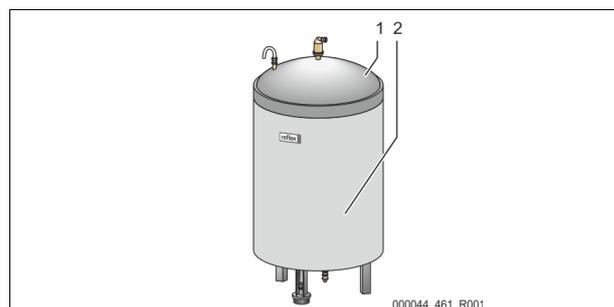
Montați termoizolația (2) opțională în jurul vasului de bază (1) și închideți-o cu fermoarul.
