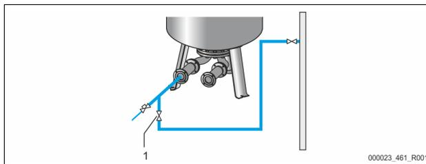
Если автоматическая система подпитки еще не подключена, то для наполнения основного резервуара водой следует воспользоваться шлангом.
