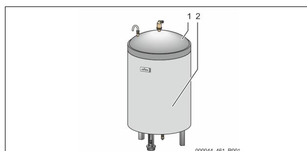
Colocar o isolamento térmico opcional (2) em volta do vaso básico (1) e fechá-lo com o fecho de correr.
