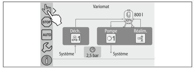
2. Ouvrez la « Soupape de réalimentation WV » en appuyant sur le bouton correspondant jusqu'à ce que le niveau de remplissage indiqué soit atteint.
