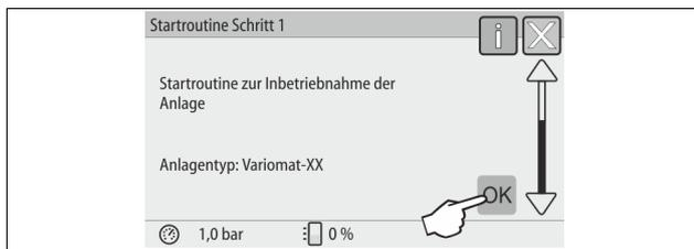
Beim erstmaligen Einschalten des Gerätes wird automatisch die erste Seite der Startroutine angezeigt:
