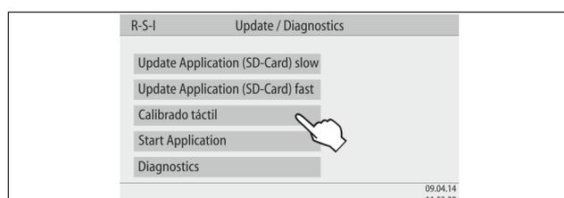
En caso de que no se haya ejecutado correctamente el accionamiento de los botones deseados, puede calibrarse la pantalla táctil.
