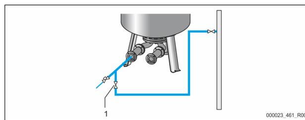
Osnovno posodo polnite z vodo skozi gibko cev za vodo, če avtomatsko napajanje še ni zaključeno.
