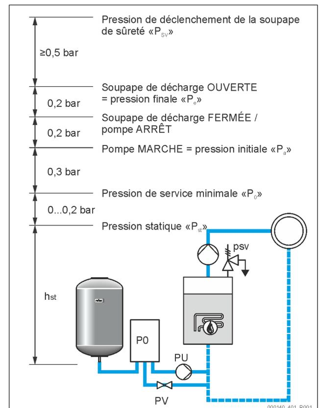
La pression de service minimale « P<sub>0</sub> » se calcule à l'aide de la formule suivante :
