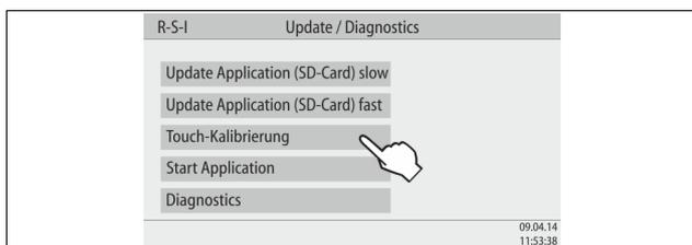
Wenn das Betätigen der gewünschten Schaltflächen nicht korrekt ausgeführt wird, lässt sich der Touchscreen kalibrieren.
