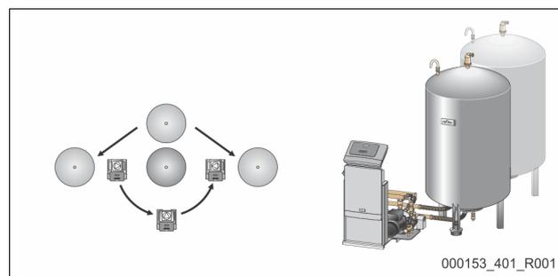
Fixez la position de l'unité de commande, des cuves de base et, le cas échéant, des cuves en aval.
