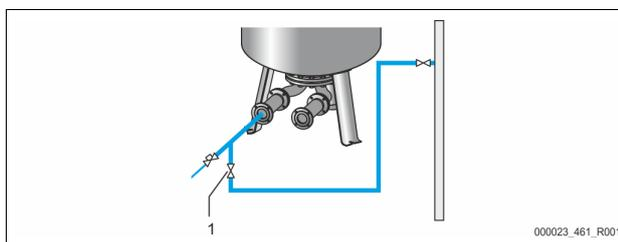
Gebruik bij voorkeur een waterslang om het basisvat met water te vullen wanneer de automatische bijvulling nog niet aangesloten is.
