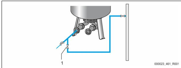
Bevorzugen Sie für das Füllen des Grundgefäßes mit Wasser einen Wasserschlauch, wenn die automatische Nachspeisung noch nicht angeschlossen ist.
