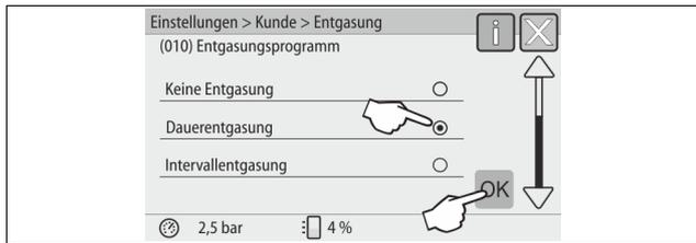
5. Zum Auswählen eines Menüpunktes, betätigen Sie den Bildlauf „unten“ / „oben“ bis der gewünschte Menüpunkt sichtbar ist.
