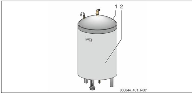
Posez l'isolation thermique (2) disponible en option autour de la cuve de base (1) puis fermez l'isolation thermique avec la fermeture à glissière.
