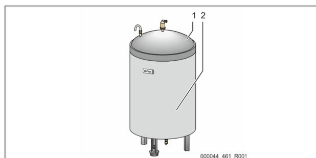
Plaats de optionele warmte-isolatie (2) rondom het basisvat (1) en sluit de isolatie met de rits.
