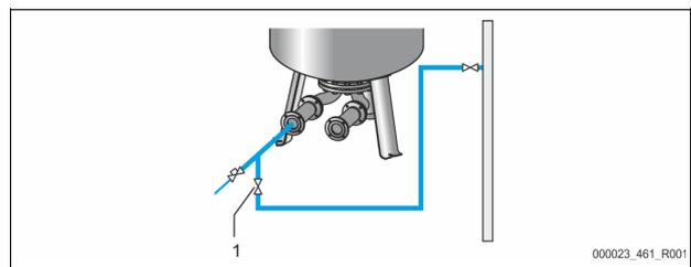
Det er bedst at fylde vand på grundbeholderen med en vandslange, hvis den automatiske efterføding endnu ikke er tilsluttet.
