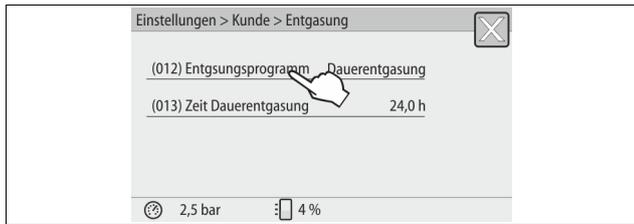
4. Betätigen Sie die Schaltfläche „(012) Entgasungsprogramm“.
