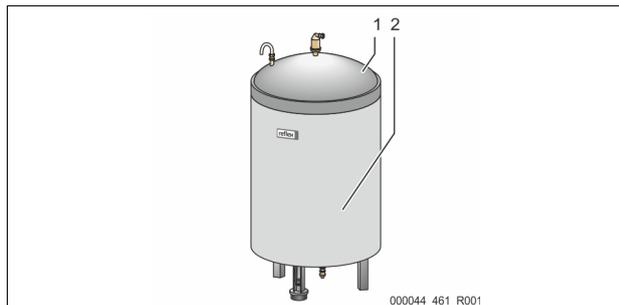
Lägg tillvalsisoleringen (2) kring baskärl (1) och förslut isoleringen med dragkedjan.
