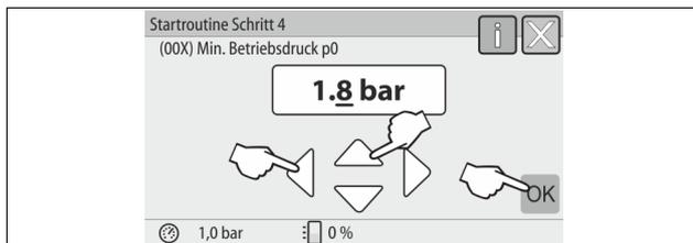
4. Stellen Sie den berechneten Mindestbetriebsdruck ein und bestätigen Sie die Eingabe mit der Schaltfläche „OK“.
