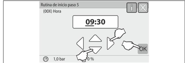
5. Ajuste la hora. Al producirse un fallo, la hora se fija en la memoria de errores de la unidad de control.
