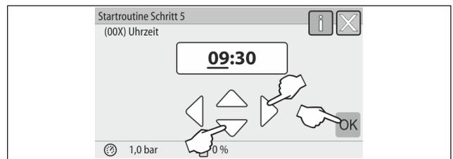
5. Stellen Sie die Uhrzeit ein. Die Uhrzeit wird beim Auftreten eines Fehlers im Fehlerspeicher der Steuerung abgelegt.
