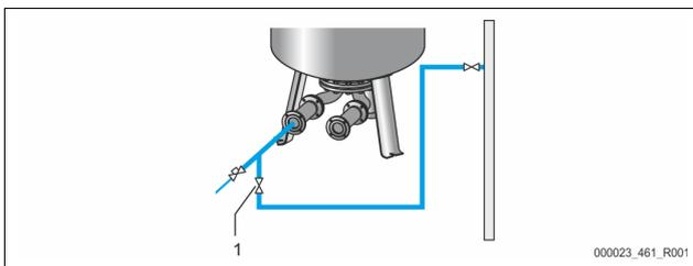
Préférez le remplissage de la cuve de base avec un tuyau d'eau lorsque la réalimentation automatique n'est pas encore raccordée.
