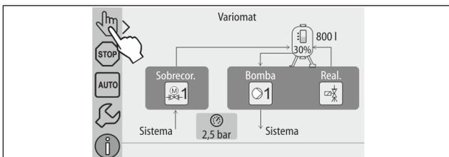
2. Mediante el correspondiente botón abra la "Válvula de realimentación WV" hasta que se alcance el nivel de llenado predeterminado.
