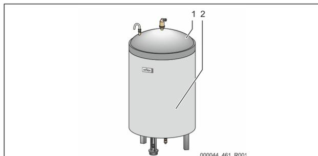
Položte alternativní tepelnou izolaci (2) kolem základní nádoby (1) a zavřete tepelnou izolaci zipem.
