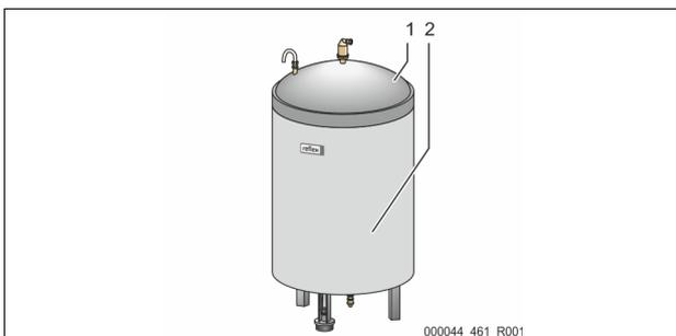
Τοποθετήστε την προαιρετική θερμομόνωση (2) γύρω από το βασικό δοχείο (1) και κλείστε τη με την ασφάλιση τύπου φερμουάρ.
