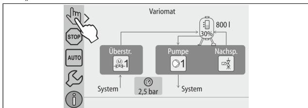
2. Öffnen Sie über die entsprechende Schaltfläche das „Nachspeiseventil WV“ solange, bis das vorgegebene Füllniveau erreicht ist.
