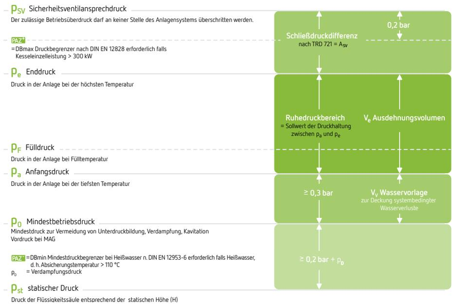
Drücke werden als Überdrücke angegeben und beziehen sich auf den Anschlussstutzen des MAG bzw. den Druckmessfühler bei Druckhaltstationen.
